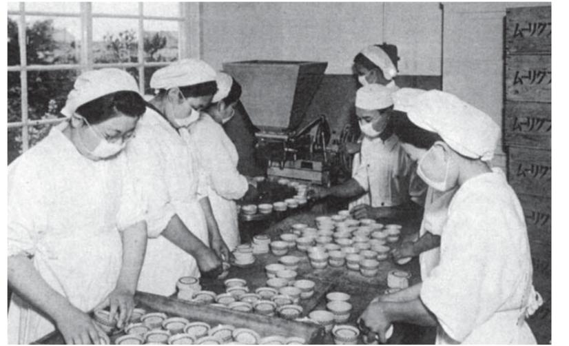
ロータリー充填機によるアイスクリームのカップ詰め作業（昭和14年）
